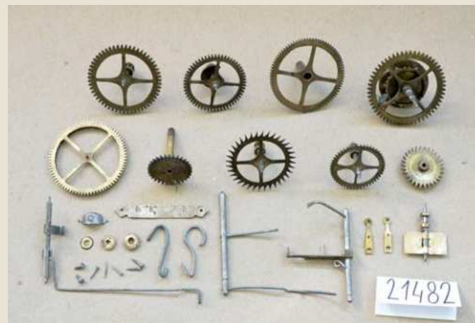
Kovové součástky hodinového strojku v průběhu čištění, 2014. (Foto Gabriela Obroučková)
