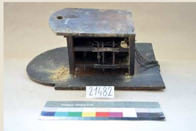
Pohled z boku na hodinový strojek, masivní znečištění prachovými částicemi a hlinou, 2014. (Foto Gabriela Obroučková)
