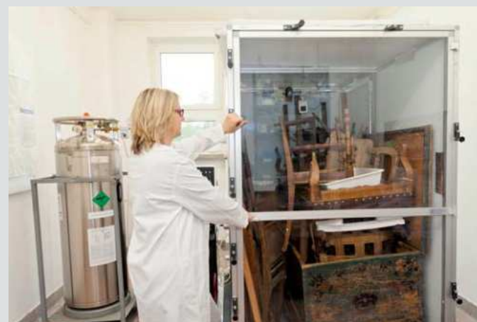
Bezkyšlíkový box pro devitalizaci dřevokazného hmyzu v atmosféře dusíku. Valašské muzeum v přírodě, 2015. (Foto Jan Kolář)
